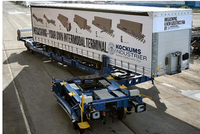
Figur 55. Kockums Megaswing-vagn med möjlighet till överföring av påhängsvagnar (Kockums Industrier)
