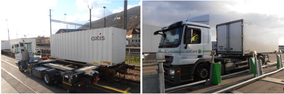
Figur 59. Innovatrains omlastningssystem ContainerMover vid Oensingen, Schweiz (Kordnejad, 2014)
