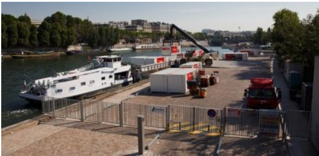
Figur 51. Lasthantering för containerinlandsvattenfartyg med truck med topplyftok (Ports de Paris, 2016)
