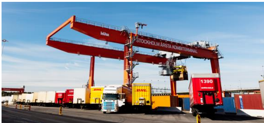
Figur 53. Topptyftning med portalkran vid Årsta kombiterminal (Jernhusen)
