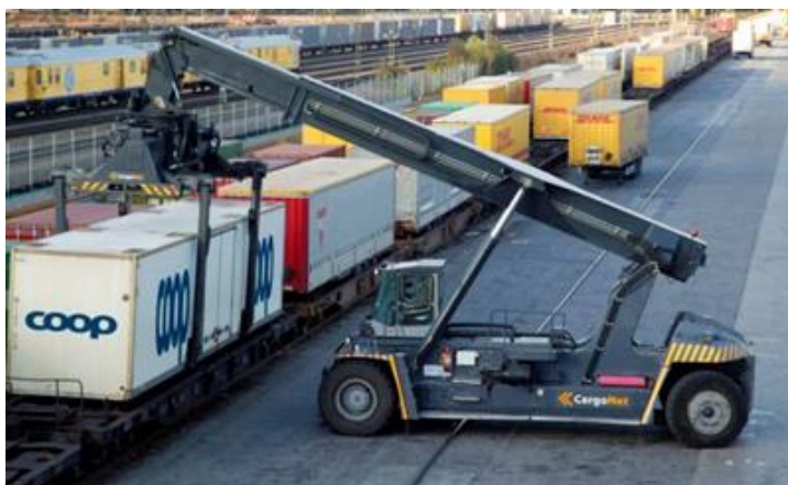
Figur 54. Griparmslyftning med en truck av typen reach-stacker (Coop)
